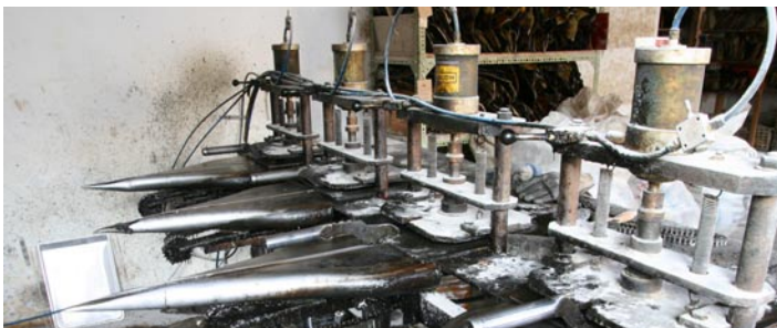
Oben die Hornaufpressmaschine und unten die Kamm-Schablonen
